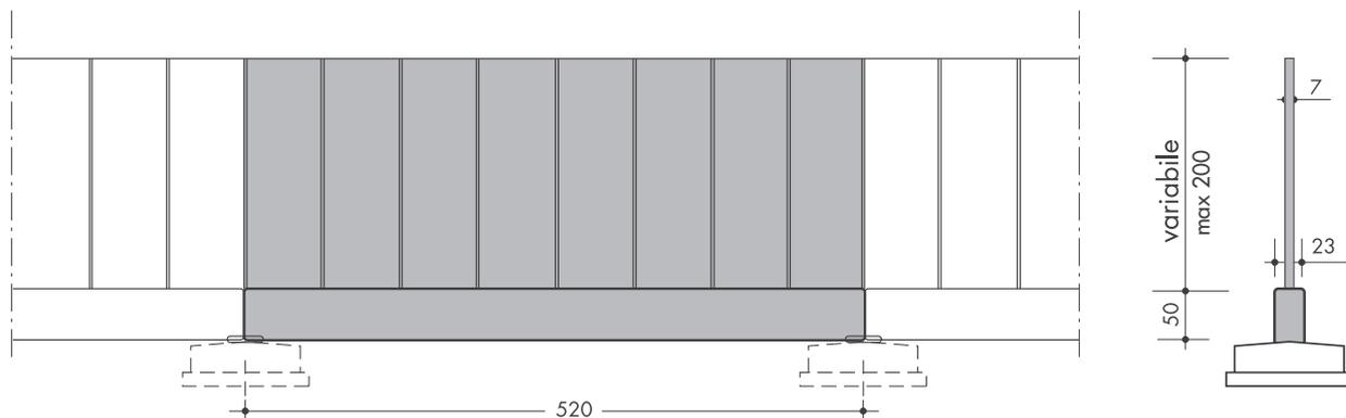
Soluzione architettonicamente molto elegante, presenta un disegno lineare con fughe verticali su entrambe le facciate. Il modulo è realizzato monoblocco privo di pilastro, la sezione è simmetrica in quanto la lastra è in asse alla trave sottostante conferendo
